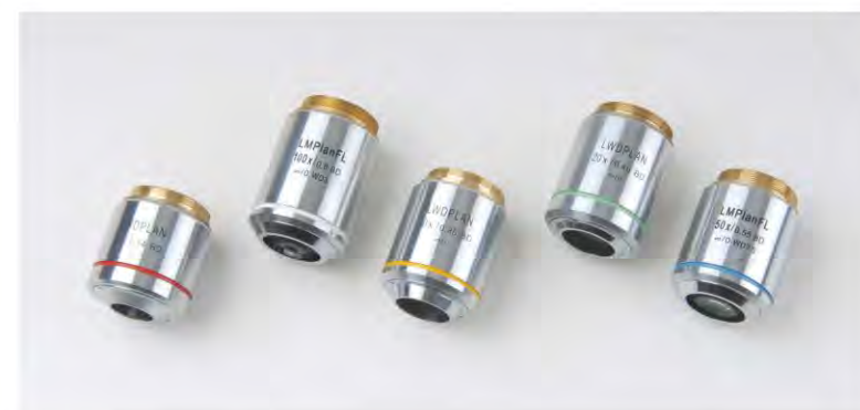
LMPL-BD无限远长工作距明暗场金相物镜
